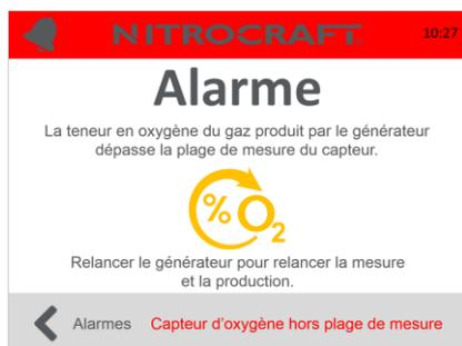
Le capteur de taux d'oxygène a mesuré un signal supérieur à sa plage de mesure maximale pendant plus de 2 minutes. L'alimentation du capteur est suspendue afin de protéger la calibration du capteur. La production d'azote est également suspendue et le générateur doit être redémarré manuellement afin d'affranchir le défaut.
