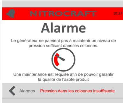
La pression au sein du générateur est insuffisante pour générer de l'azote aux caractéristiques nominales de l'appareil.
