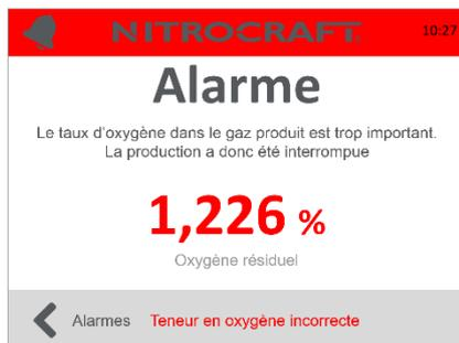
Un taux d'oxygène supérieur au taux nominal de votre appareil a été détecté dans l'azote produit. La production d'azote est stoppée et le générateur travaille sur lui-même. La production d'azote reprendra si le taux d'oxygène redevient acceptable (cf. §6.7).
