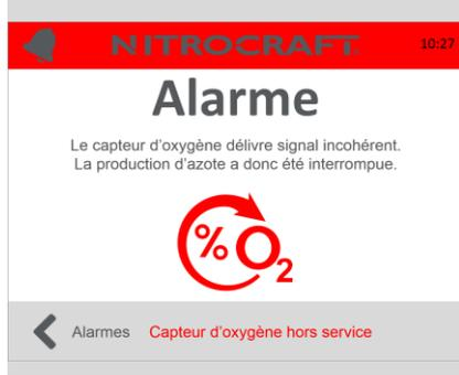
Si le capteur de taux d'oxygène est identifié comme étant en défaut, la vanne de sortie d'azote est immédiatement fermée et le générateur fonctionne jusqu'à une heure sur lui-même afin de récupérer son signal puis s'éteint en cas d'échec.
