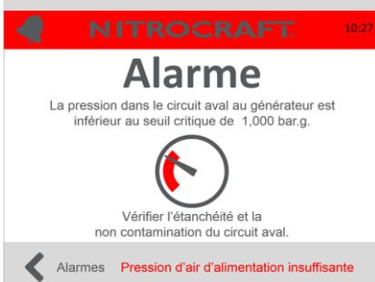
La pression dans le circuit aval du générateur est inférieure au seuil critique programmé. L'intégrité de l'enceinte contenant l'azote peut être compromise l'exposant ainsi à une contamination externe.
