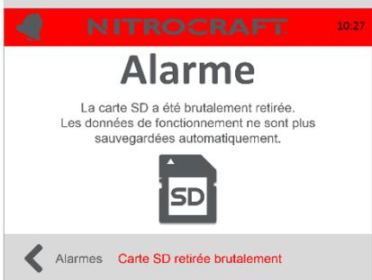
La carte SD a été retirée de l'automate sans suivre la procédure d'éjection normale (cf. §5.4.7.1.3). Vos données de fonctionnement ne sont plus automatiquement enregistrées.
