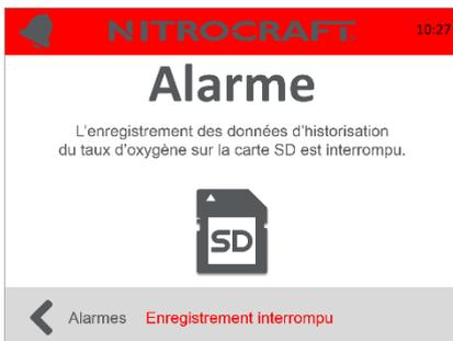
Un problème est survenu lors du dernier enregistrement de données sur la carte SD du générateur. Les dernières données de fonctionnement du générateur, notamment l'enregistrement en continu de la teneur résiduelle en oxygène du gaz produit, n'ont pas pu être enregistrées (cf. §6.12).
