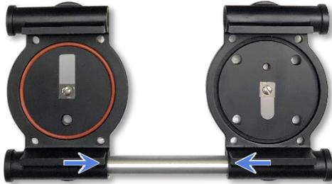
37. Remettre en place les boîtes à clapets en prenant soin d'**aligner les 4 perçages** de chaque boîte avec les trous taraudés du bâti du compresseur et la gorge de la boîte à clapets **BP** avec le cylindre **BP**.
