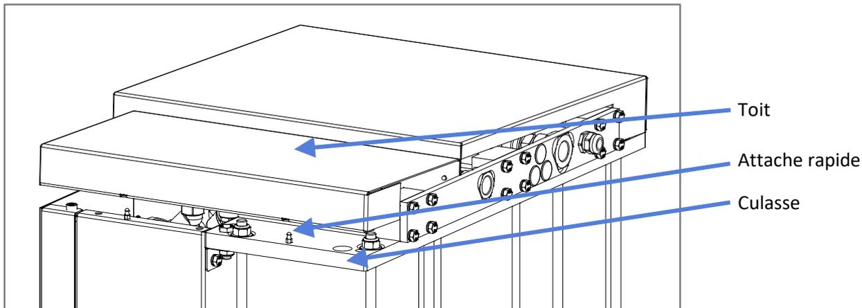
Il est nécessaire d'ôter les panneaux avant du générateur afin d'accéder aux composants électriques et pneumatiques placés dans le coffre. Pour cela, démonter le toit du générateur pour accéder aux 2 vis M8 placées sur la face supérieure des panneaux.
